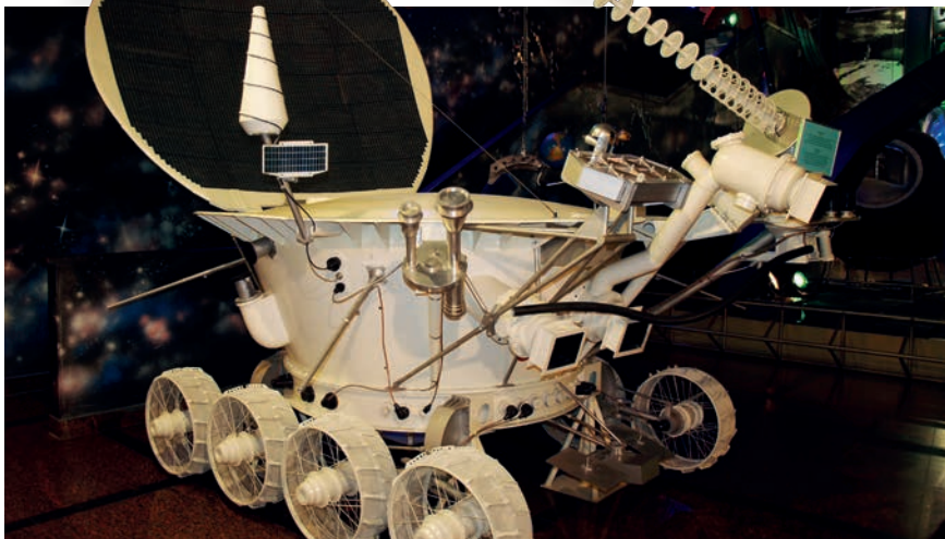
Самоходный аппарат-планетоход «Луноход-2», который в январе 1973 года с помощью автоматической станции «Луна-21» был доставлен на Луну в район моря Ясности. За пять лунных суток в условиях сложного рельефа прошел расстояние 37 км
